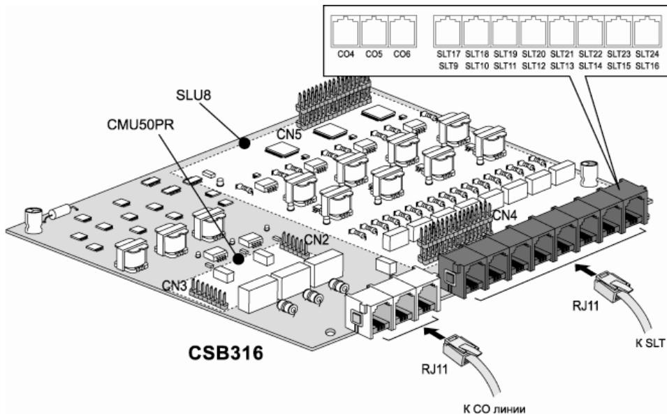
Рис. 2.13 Плата 3-х внешних линий и 16-и аналоговых абонентов CSB316
