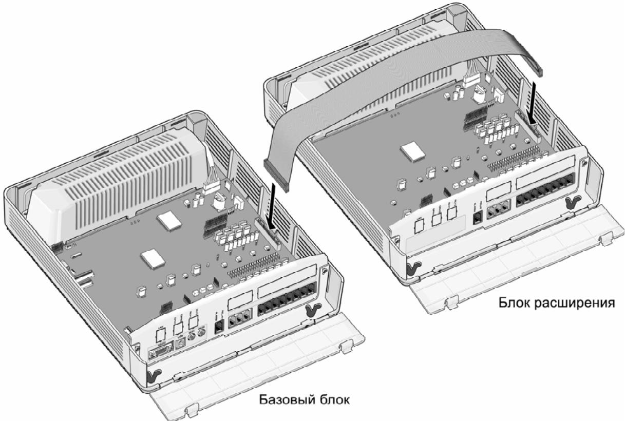
**Рис. 2.8 Подключение блока расширения к базовому блоку**
