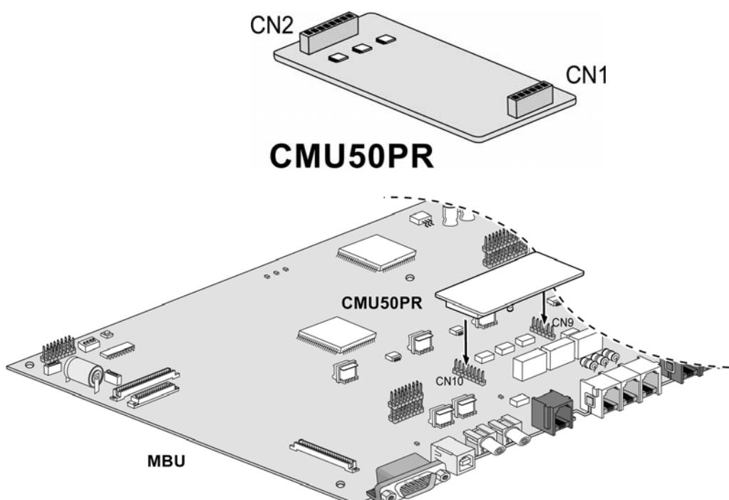
Рис. 2.20 Модуль определения импульсов тарификации CMU50PR
