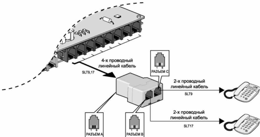
Рис. 2.14 Терминальный переходник
