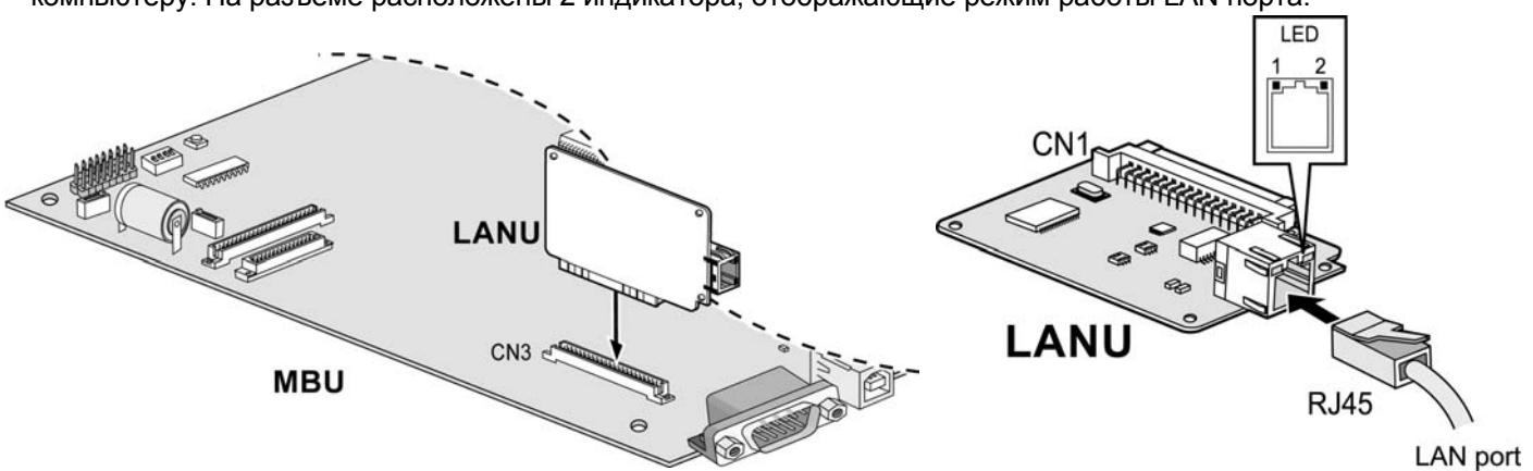
Рис. 2.17 Сетевой модуль LANU
