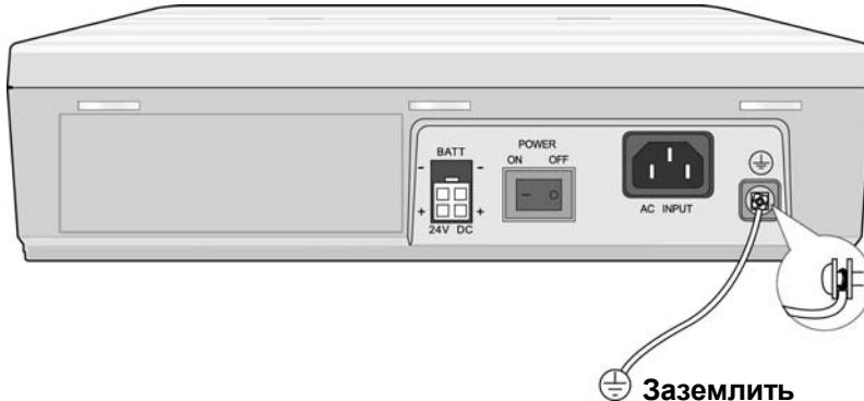
Рис. 2.3 Заземление корпуса
